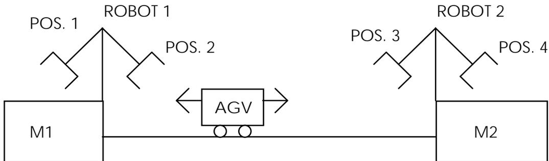
Il robot 1, se in posizione 1, preleva un pezzo dal magazzino M1 e lo deposita sull'AGV nella posizione 2, se quest'ultimo è presente. Una volta caricato, l'AGV si sposta dalla posizione 2 alla posizione 3. Quindi il robot 2, se in posizione 3, preleva il pezzo presente sull'AGV, si porta in posizione 4 e lo deposita sulla macchina M2 quando questa è libera.
